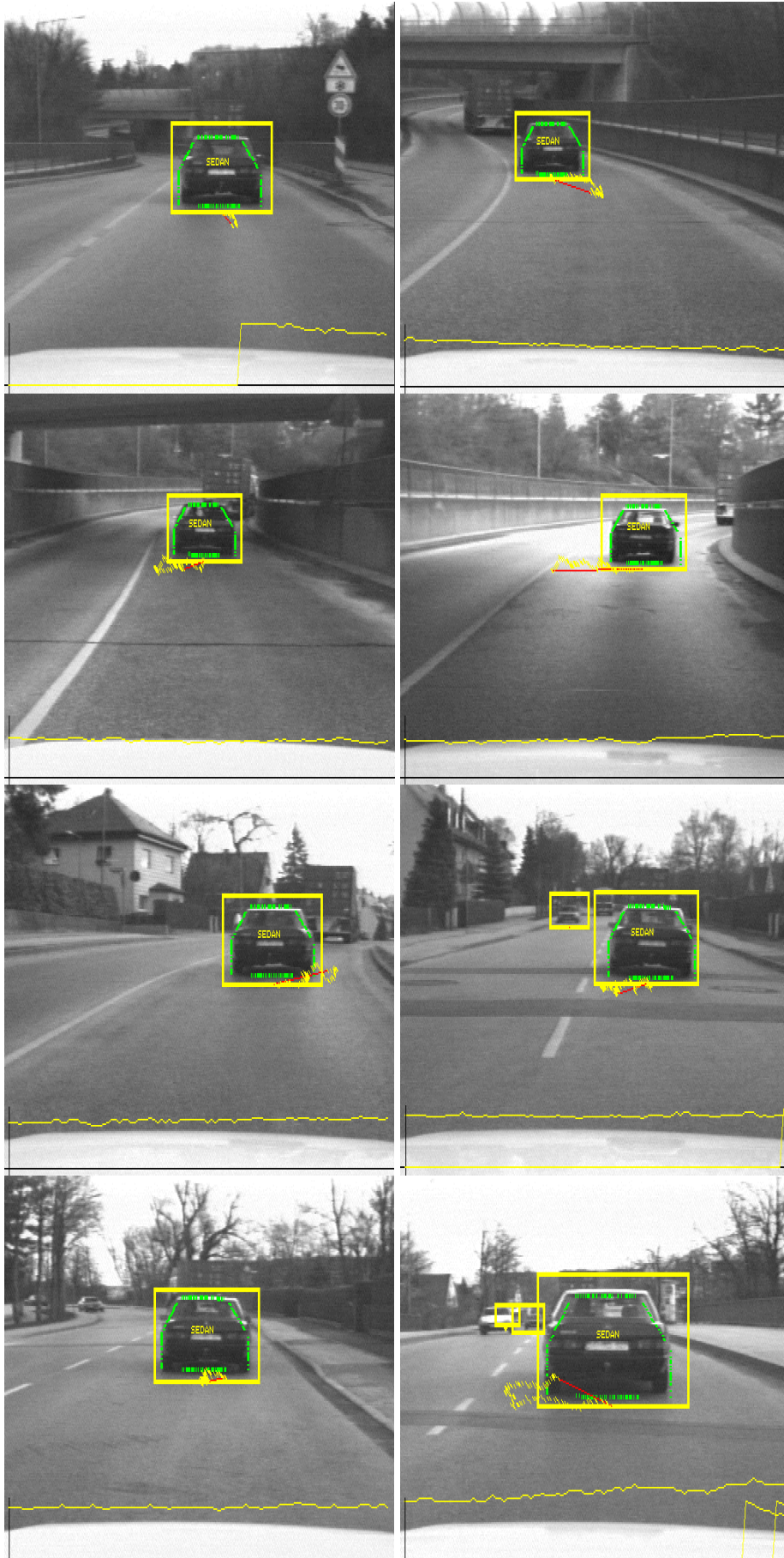
Abbildung 4: Objektdetektion, Objektklassifikation und Objektverfolgung an einer Sequenz von 1000 Bildern mit unterschiedlichen Beleuchtungsverhältnissen
