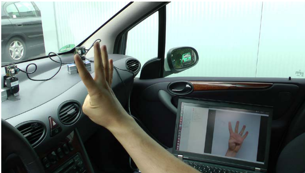
Abbildung 3: Gestenerkennung im Fahrzeug (Testsystem)
