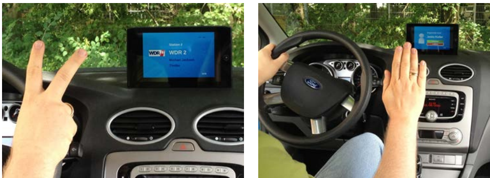
Abbildung 2: Mock-up Demonstration zur Auswahl eines Radio-Presets und Ablehnen eines eingehenden Anrufs.
